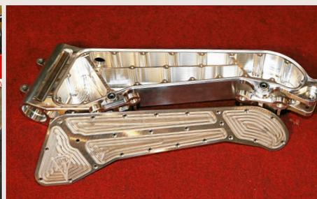
**Tragendes Teil: der aus dem Vollen gefräste, leichte Alu-Kastenrahmen**
